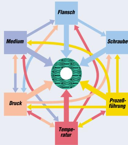
Dies ist jedoch leider nicht richtig: Die maximale Einsatzfähigkeit von Dichtungen hinsichtlich Druck und Temperatur definiert sich über eine Vielzahl von Einflußgrößen. Demnach ist eine allgemein verbindliche Angabe dieser Werte für Dichtungen prinzipiell nicht möglich.
